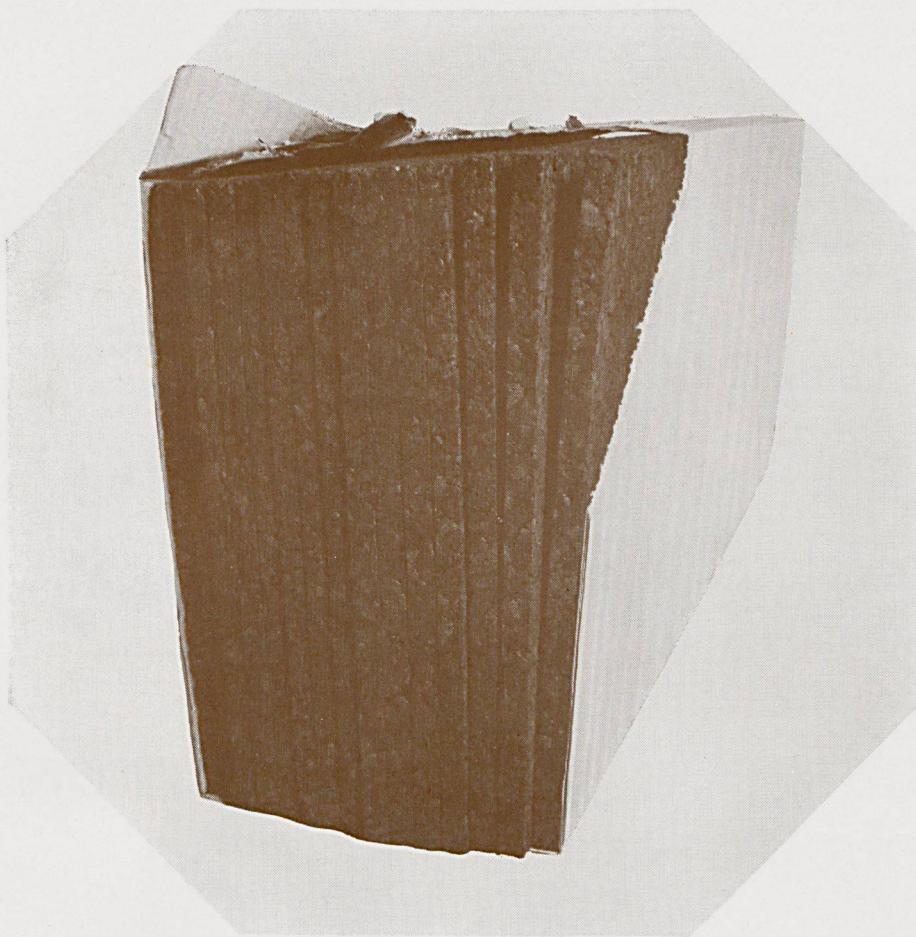
Oder noch extremer ausgedrückt: Eine 1 cm starke Korkplatte besitzt denselben Isoliereffekt wie eine Betonmauer von 41 cm Dicke. Das verdankt er seiner äusserst niedrigen Wärmeleitzahl.
