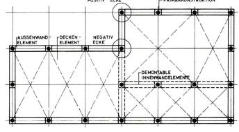
Knotenpunkt in einem linearen, räumlichen System. Nœud constructif dans un système tridimensionnel linéaire.
