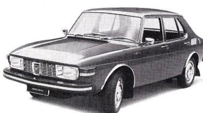
Selbstverständlich bietet Ihnen der SAAB 99 noch viel mehr: Scheinwerfer-Wischer/Wascher, Fahrersitz mit thermostatisch gesteuerter Sitz-Temperatur, Blechstärke 0,9–2,5 mm, extremen Rostschutz und Hohlräumversiegelung, Überrollbügel, vier Scheibenbremsen, drei Bremssysteme, Gummireifen mit Abnutzungswarnsektoren, Sicherheitslenksäule.
