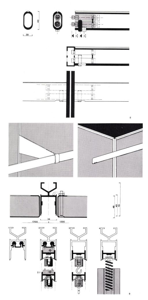
9 Untergehängte Decke (Ziffern vergl. mit Text). Plafond suspendu (Voir les chiffres du texte). Suspended ceiling (Cf. numbers in text).
