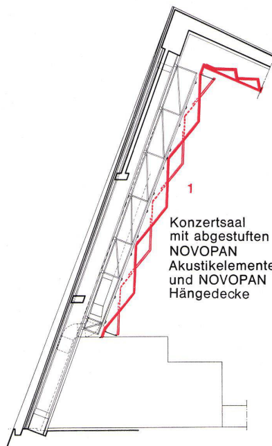
Konzertsaal Schrägschnitt, Vertikalschnitt Elemente aus NOVOPAN 40 mm, furniert und NOVOPAN Hängedekce
