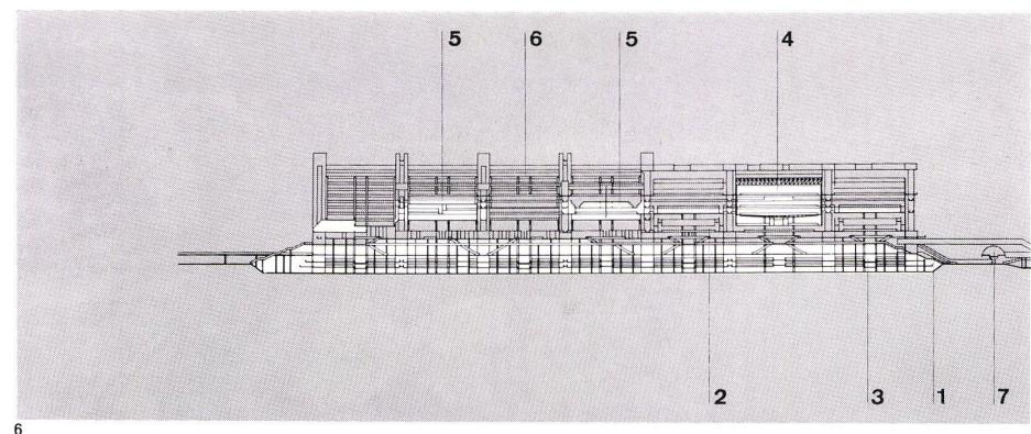
sen, an einer durch das Gebäude führenden »inneren Straße« sind Autobushaltestellen und Taxiplätze vorgesehen. Rolltreppen führen von hier auf die Ebene der Rollbänder (Niveau +21,25 m), die die Verbindung zur hochliegenden U-Bahn herstellen. Von dieser Fußgängerpassage werden die exterritorialen Zonen nach Passieren einer Kontrolle mit Rolltreppen erreicht.
