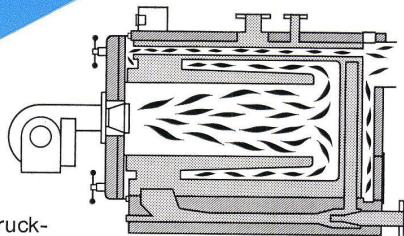
CTC Überdruckkessel für Überbauungen, Hochhäuser, Kommunal- und Industriebauten. Der CTC Überdruckkessel, Typ 1200, ist speziell für Öl- und Gasfeuerung konstruiert. Lieferbar mit oder ohne Zellen-Hochleistungs-Boiler aus Chromstahl.
