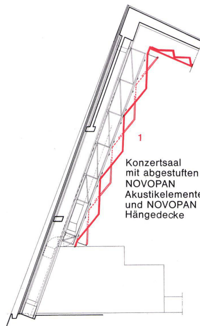
Konzertsaal Schrägwand, Vertikalschnitt Elemente aus NOVOPAN 40 mm, furniert und NOVOPAN Hängedecke
