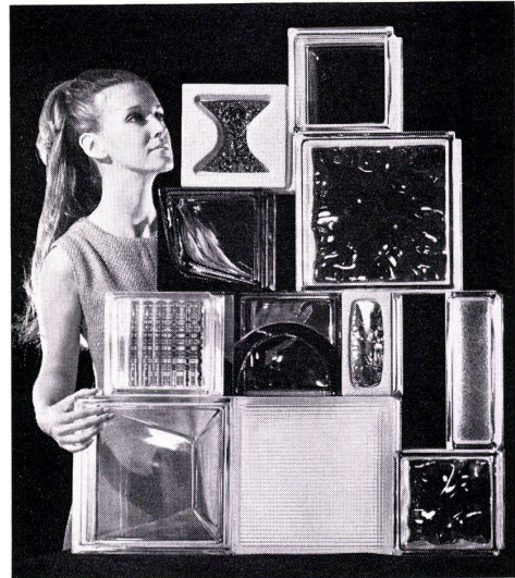
Glasbausteinwand aus Reliefsteinen CHIARO I und CHIARO II. Die CHIARO-Steine wurden für PCC von der bekannten Design-Firma Peter Muller-Munk Associates entworfen und weisen beidseitig ein stark erhobenes, von schwarzem, abriebfestem Email betontes Relief auf.
