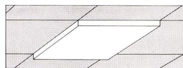
Apropos Abdeckung: Sie ist aus opalisiertem Acrylglas von durchgehend gleicher Dicke und Festigkeit, nach unserem eigenen Verfahren scharfkantig gebogen (ein Verfahren nobis, das uns erlaubt, unabhängig von fixen Massen Abdeckungen in genau der Form und Grösse zu bauen, wie sie für den einzelnen — für Ihren Fall erforderlich sind).
