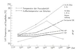
Sechster Versuch: Verlauf der Raumlufttemperatur in Kopfhöhe bei drei Lamellenstellungen (außen) im Vergleich zu den Außentemperaturen.
