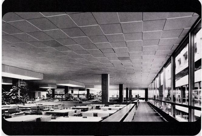
Aha! Schon wieder ein anspruchsvolles Objekt, dessen Decke mit Odenwald-Mineralfaserplatten ausgeführt wurde. 2700 m² auf einer Fläche – die gefällige, plastische Wirkung lässt sich nicht übersehen. Ausserdem ermöglichen die durchbohrten Platten eine Luftumwälzung von 40'000 m³ pro Stunde. Alles in allem: Eine betont ange-
