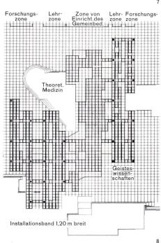
7 Schema der Verkehrserschließung und Installationsverteilung als Strahlennetz.
