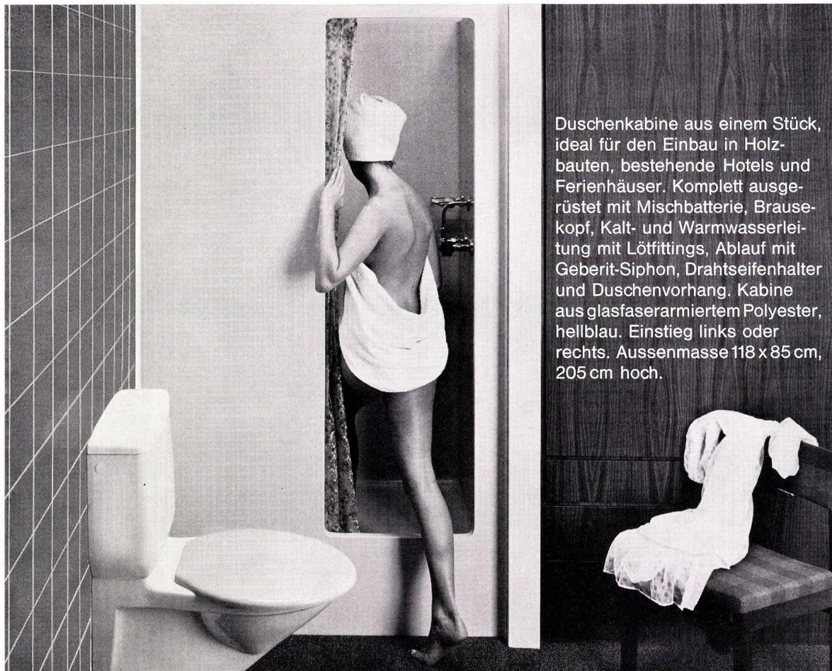
Duschenkabine aus einem Stück, ideal für den Einbau in Holzbauten, bestehende Hotels und Ferienhäuser. Komplett ausgerüstet mit Mischbatterie, Brausekopf, Kalt- und Warmwasserleitung mit Lötfittings, Ablauf mit Geberit-Siphon, Drahtseifenhalter und Duschenvorhang. Kabine aus glasfaserarmiertem Polyester, hellblau. Einstieg links oder rechts. Außenmasse 118 x 85 cm, 205 cm hoch.
