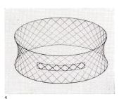
wasserdichtes Dachelement infolge der Herstellungsmöglichkeiten aus rissefreiem Spannbeton;
