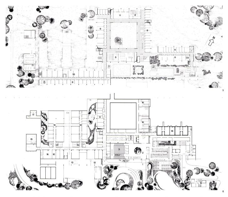
Im Gegensatz zum Kammsystem sind bei einer ringförmigen Gesamtdisposition Erweiterungen im kleinen Rahmen erschwert.
