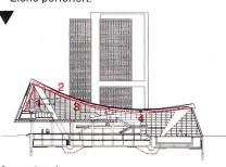
Konzertsaal Längsschnitt, Hängedach und Schrägfassade
