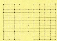
Konstruktives Schema, Hauptträger (Durchlaufträger), Nebenträger (Spannweite 7,80 und 11,70).
