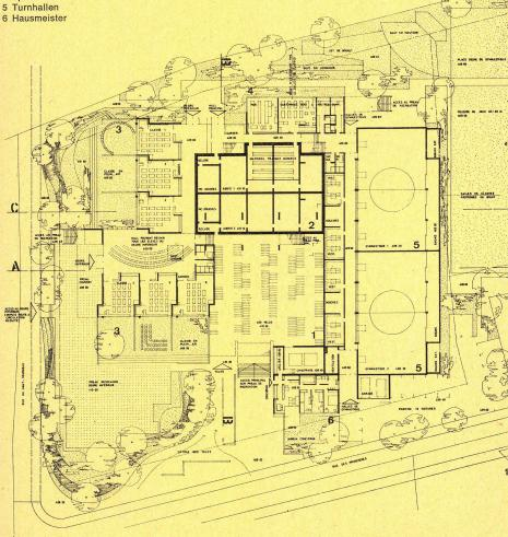
Konstruktion: Vorfabrizierte Stahlelemente, Fassadenelemente Sandwich-Platten, die tragende Struktur liegt im Inneren. Die Wahl der Konstruktion ohne tragende Wände erlaubt ein schnelles und leichtes Anpassen an veränderte Unterrichtsmethoden.
