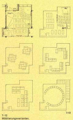
Konstruktion: Stahlbetonskelett. Die Klassentrennwände sind nichttragend ausgebildet. Die Unterrichtszonen können Änderungen der Unterrichtsmethoden angepaßt werden.
