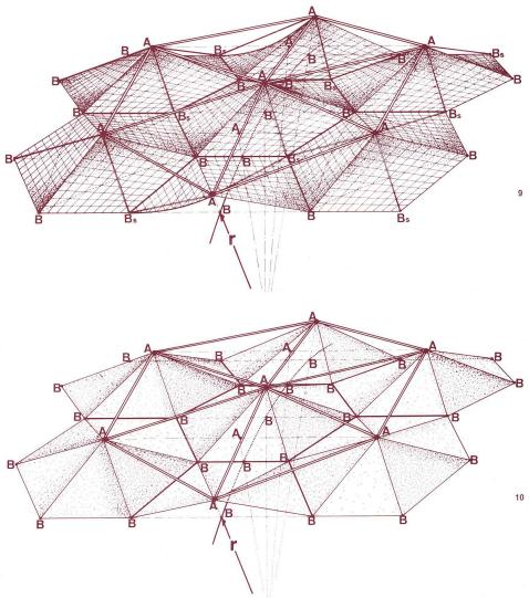
9, 10, 11, 12 Beispiele für die Kombination von Stab- und Flächentragwerken, die an der Structural Plastics Research Unit der University of Surrey entwickelt wurden.
