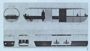
Beim Stillstand ruht die Kabine des URBA auf horizontalen Flügeln unter dem Leitbalken. Beim Anfahren heben die Turbinen die Kabine mittels Unterdruckkammern und halten sie im ärostatischen Gleichgewicht, ohne daß sie den Leitbalken berührt.
