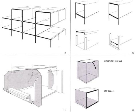
als Raumelemente hergestellt. Auch in diesem Falle müssen bei geschlossenen Raumzellen die Boden- und Deckenplatten in einem anderen Arbeitsgang betoniert werden. Nur bei quergeteilten offenen Zellen ist es möglich die Elemente für die Fabrikation zu drehen und sie in einem Stück zu gießen.
