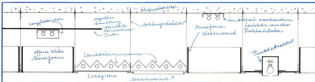
Einige Möglichkeiten der Beleuchtung durch das neue Deckensystem Minaform 625®.
