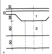
Ergebnis von Konstruktionswettbewerb und Ausschreibung: Flache Balken mit Verbreiterungen an den Auflagern und flache Druckplatte. Wirtschaftliche Konstruktion (Angebotspreis) mit den Vorteilen der freien Zone für Installation.
