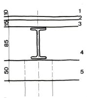
Integration von statischer Konstruktion mit freier Zone für Luftkanäle durch hohe Balken mit Regelaussparungen mit dünner Druckplatte.
