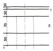
Addition einer Flachdecke (zum Beispiel Pilzkonstruktion) mit einer konstruktionsfreien Zone, das heißt freie Beweglichkeit für die Installation ohne Einengung von konstruktiven Teilen.
