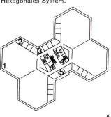
Grundschema aus gleichen sechseckigen Flächeneinheiten von je 1000 m<sup>2</sup>.
