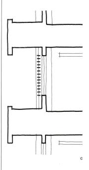
Für außen geeignete bewegliche Sonnenschutzanlagen müssen mindestens in jeder Konstruktionsachse (9,90 m) wegen der Windbelastung in Führungsschienen laufen. Diese Führungsschienen erschweren die Fassadenbildung besonders an den Ecken des Gebäudes (unterschiedliche Breiten, Doppelpfosten wegen Richtungsänderung). Starke Verschmutzung möglich.
