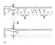
Schema der Zuluft- und Abluftführungen.
