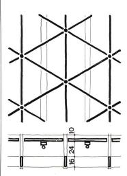
Deckenelemente (Oberdecke und Blendraster) entsprechen dem kleinsten Flächenmodul (etwa 82 cm Seitenlänge). Befestigung erfolgt an Rohrstücken in den Rasterpunkten (siehe auch Klimatisierung).
