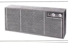
Der Copperad-Minivektor, ein kleiner Ventilator-Konvektor, kann auf einfache Art an oder in jeder Wand horizontal oder vertikal montiert werden. Das Heizelement wird an die Zentralheizung angeschlossen. Auf Wunsch wird das Gerät mit einer zusätzlichen Elektro-Heizung geliefert.
