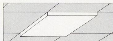
Apropos Abdeckung: Sie ist aus opalisiertem Acrylglass von durchgehend gleicher Dicke und Festigkeit, nach unserem eigenen Verfahren scharfkantig gebogen (ein Verfahren notabene, das uns erlaubt, unabhängig von fixen Massen Abdeckungen in genau der Form und Grösse zu bauen, wie sie für den einzelnen — für Ihren Fall erforderlich sind).
