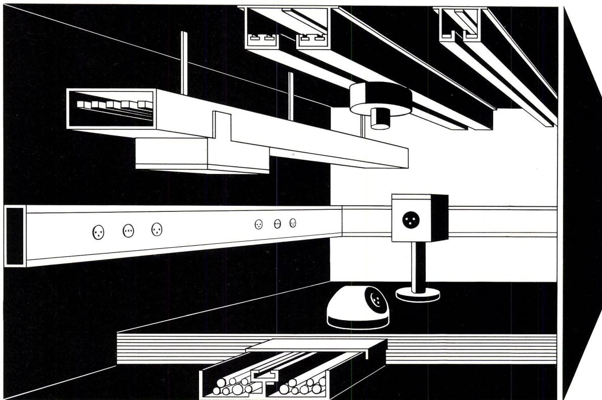
Stromkanäle bis 400 A, 500 V
