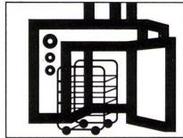
Lacktrockne- & Einbrennöfen, Kammer- oder Tunnelprinzip, Normbau, elektrisch oder ölgefeuerd
