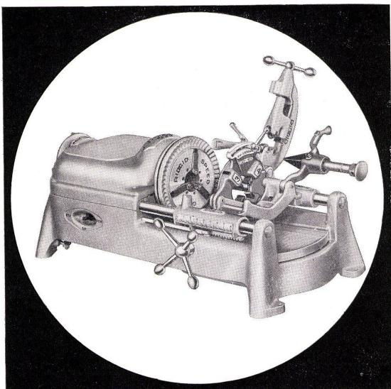
Eine komplette Installateurwerkstatt: Rohrrinnenfräser, Schneidkluppen und Rohrschneider sind in der Reihenfolge des Arbeitsablaufes fest angeordnet.
