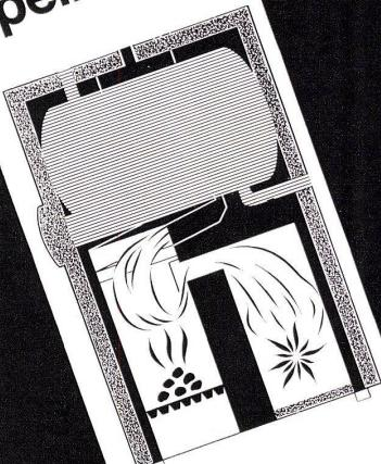
Dank zwei getrennten Brennkammern ist jederzeit, ohne Umstellung am Kessel, ein Verfeuern von Öl und festen Brennstoffen möglich. Die separate Brennkammer für feste Brennstoffe ist so dimensioniert, dass auch zu Zeiten von Ölverknappung eine normale Heiz- und Warmwasserleistung garantiert ist.
