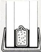
Das Geheimnis der "ATERPHONE" Verglasung : 2 **weiche** Fugen in einem **festen** Rahmen. Die Dauerbiegsamkeit der Fugen wird leicht jede Dehnung auffangen. Der feste Rahmen aus rostfreiem Stahl vermeidet jede Kantenverformung.
