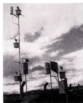
6 Meßgeräteanordnung zur Registrierung des Schlagregens.
