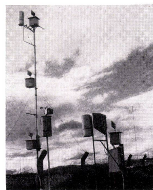
6 Meßgeräteanordnung zur Registrierung des Schlagregens.
