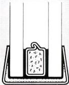
Das Geheimnis der "ATERPHONE" Verglasung : 2 **weiche** Fugen in einem **festen** Rahmen. Die Dauerbiegsamkeit der Fugen wird leicht jede Dehnung auffangen. Der feste Rahmen aus rostfreiem Stahl vermeidet jede Kantenverformung.
