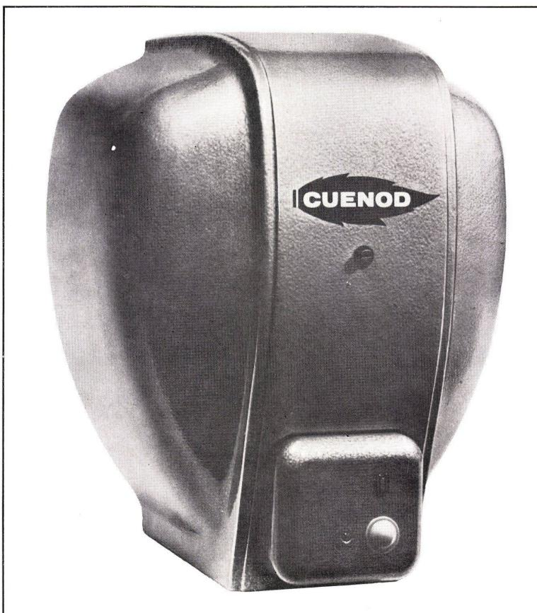
Cuenotherm, die letzte Neuheit auf dem Gebiete der CUENOD-Brenner, wurde für Heizungsanlagen von Villen, Chalets und kleinen Häusern entwickelt. Der Brenner läuft vollständig automatisch mit einer Leistung von 1,5 bis 4 kg/h, geringem Unterhalt und ermöglicht in Folge seines eingeschlossenen Steuerkastens einen einfachen Einbau.
