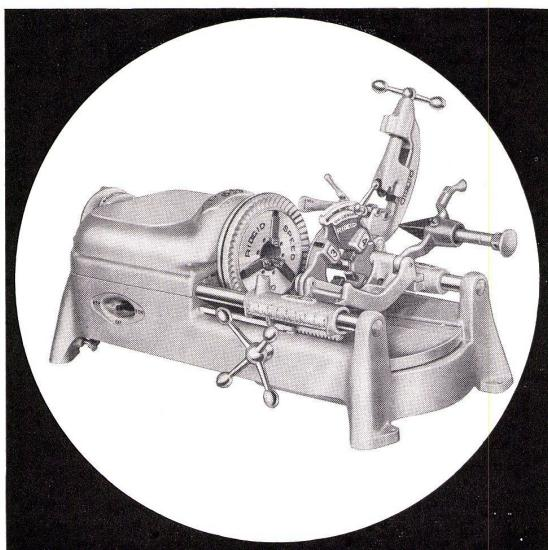
Eine komplette Installateurwerkstatt: Rohrinnenfräser, Schneidkluppen und Rohrschneider sind in der Reihenfolge des Arbeitsablaufes fest angeordnet.
