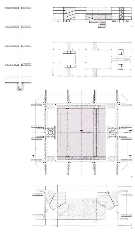
Schnitt mit Fertigteilstützen und Hubdecken. Coupe des supports préfabriqués et des plafon-
