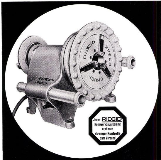
Der elektrische Antrieb 300 kann fest auf der Werkbank, oder als bewegliche Maschine auf dem Dreifuss 1206 montiert werden. Er ist mit Sicherheits-Schnellspannfutter RIDGID, das sich unter Belastung nicht öffnen lässt, ausgerüstet. Die hintere Führung hält lange Rohre genau zentrisch. Der elektrische Antrieb 300 kann ergänzt werden durch die praktischen und preiswerten Zusatzgeräte: Halter 311, Rohrinnenfräser 340, Rohrschneider 360 und den entsprechenden Kluppen.
