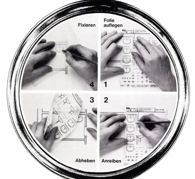
Verblüffend einfacher Vorgang. Saubere Darstellung der meistverwendeten sanitären Apparate im Masstab 1:20, 1:50 oder 1:100. Darstellungsart auf Plattenraster 15,3 cm
