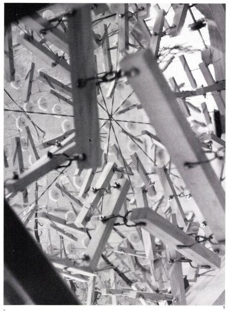
Belastungseinrichtung der Modellanlage. Dispositions pour essais en maquette de différents cas de charge.
