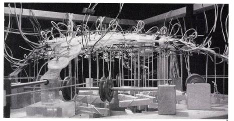
Beim Neubau der Firma Kilcher galt es mit einer Schalenkonstruktion einen Raum von 400 m² Fläche stützenfrei zu überdecken. Neben den üblichen Bedingungen wie Belichtung, Isolation, kurze Bauzeit und geringe Kosten stellte der Bauherr vor allem die Forderung nach einer ästhetisch hochwertigen Konstruktion, die den neuesten Stand der Forschung darstelle.
