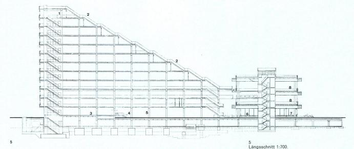
Longitudinal section. 1 Technisches Geschoß / Niveau d'installations / Installations level
