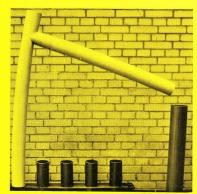
Mit diesem Versuch wird die Festigkeit von maschinell eingeschweißten Abzweigungen untersucht. Das abzweigende Rohr steht während längerer Zeit unter Belastung, so daß erhebliche Kräfte an den Schweißstellen entstehen.
