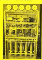
Sämtliche Schweißnähte, die in der Werkstätte ausgeführt werden, werden mit einem Funkeninduktor auf Dichtheit geprüft. Auf diese Weise werden kleinste Undichtheiten aufgedeckt. Im Bild rechts ist der Prüfstand für Zeitstandsuntersuchungen abgebildet. Hier werden Rohre und Rohrverbindungen während Tagen unter Druck und hoher Temperatur getestet. Die Lebensdauer gibt dabei Aufschluß über die Qualität.
