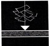
Spezielle, kreuz und quer verleimte Feinspäne ergeben eine millimeterdicke, richtungslose, tadellos plane und dichte Absperrung. Deshalb die schöne und ruhige Oberfläche jeder NOVOPAN-Platte!
