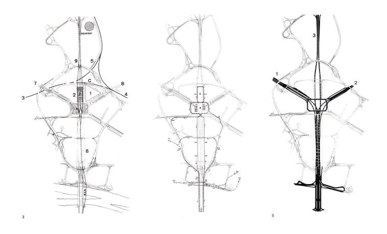
6 Schema der Verkehrswege 1:10 000. Schéma des circulations. Diagram of traffic system.
