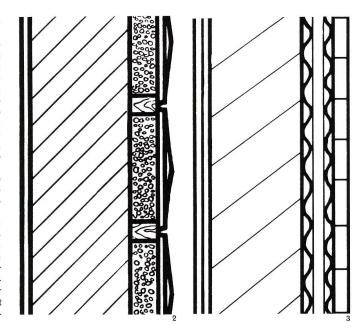
Detailschnitt durch ein Außenwandelement. Von links nach rechts: Innensichtfläche (Putz); Stahlbeton (tragende Schicht); Corblanit (wärmedämmende Schicht); geprägte Alu-Kassetten (Wetterschutzaußenhaut).
