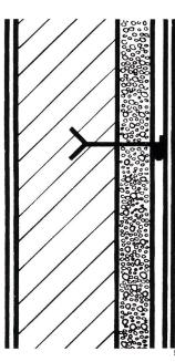
Detailschnitt durch ein Außenwandelement. Von links nach rechts: Innensichtfläche; Stahlbeton (tragende Schicht); T-Platte (anorganische Wärmedämmplatte); Waschbeton (Wetterschutzaußenhaut).
