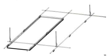
Die Decke kann, weil die Zwischenwand separat an den Stützen befestigt ist, völlig frei abgehängt werden.
