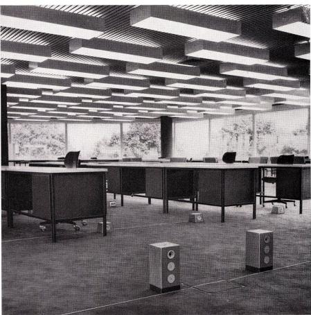
Teli-Flur, das Elektro-Installationssystem in Fußboden und Fensterbankkanal, ist der Träger aller Leitungswege für Starkund Schwachstrom.
