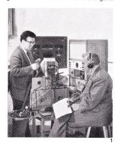
Magnettonapparatur zum Hörbarmachen der Akustik eines Raumes über Frequenztransponierung im Verhältnis des Modellmaßstabes.
