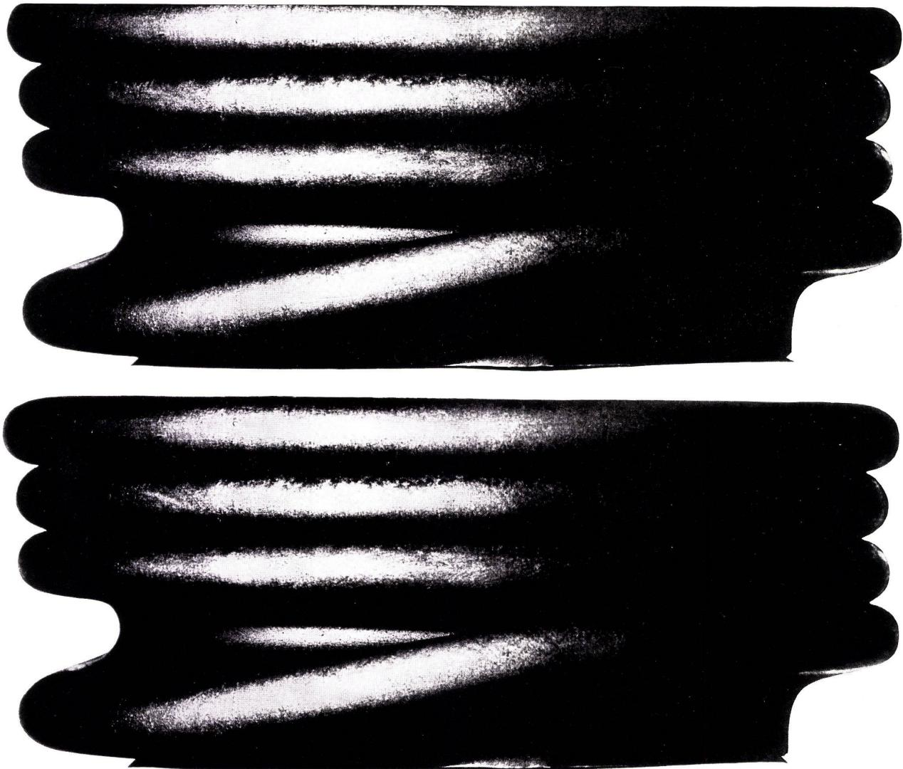
Stauchproben bilden nur einen Teil der umfangreichen Prüfungen, welche laufend während der Fabrikation von ARFA Rohren durchgeführt werden. Sie sind ein Beweis für die Güte der Schweißung und die Verformbarkeit des verwendeten Stahls.
