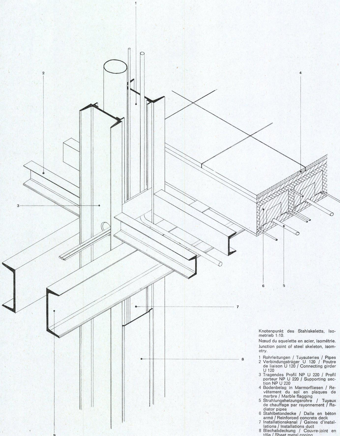
Knotenpunkt des Stahlskeletts, Isometrieb 1:10.
