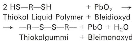
Durch diese chemische Reaktion werden die Ausgangsprodukte irreversibel vernetzt.
