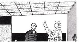
Jede Platte kann einzeln ausgewechselt werden. Dadurch sind nachträgliche Änderungen an der Installation im Deckenhohlraum möglich.
