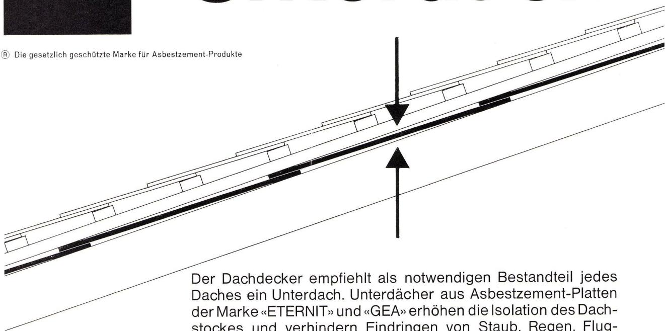
Der Dachdecker empfiehlt als notwendigen Bestandteil jedes Daches ein Unterdach. Unterdächer aus Asbestzement-Platten der Marke «ETERNIT» und «GEA» erhöhen die Isolation des Dachstockes und verhindern Eindringen von Staub, Regen, Flugschnee und Rückschwallwasser.
