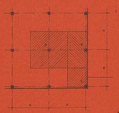
Belastungsschema von Mittel-, Rand- und Eckstützen in einem quadratischen Rastersystem.
