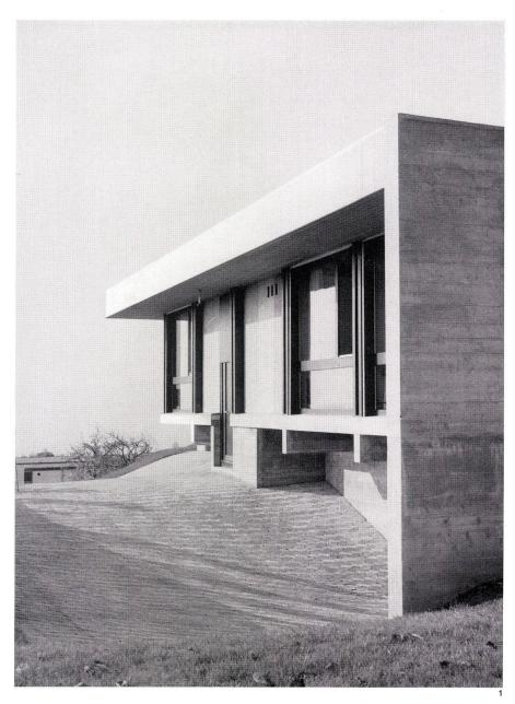
Das Erdgeschoß kragt überall über das Gartengeschoß aus, zwischen den Unterzügen unter der Gartengeschoßdecke befinden sich die Fenster für dieses Geschoß.
