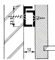
Technische Daten:. Tragkraft 20 kg Platzbedarf seitlich je 12 mm Auszugsverlust je nach Länge 7-12 cm
